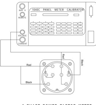
3 PHASE POWER FACTOR METER FOR BALANCED SYSTEM
